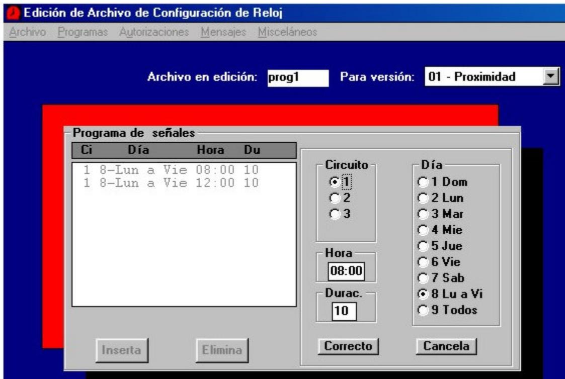
Los relojes colectores de datos disponen de una función que permite controlar una salida, programable semanalmente, para operar dispositivos de señales audibles como campanas, sirenas, etc. .
